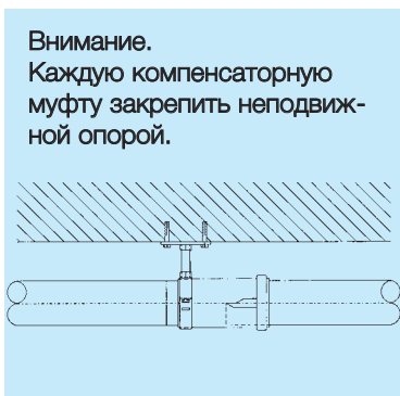
Ввести трубу в компенсаторную муфту
